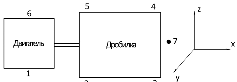
Рис. 2 – Схема расположения точек измерения вибрации дробилки
